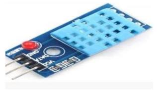
Figure 3 DHT11 Sensor
