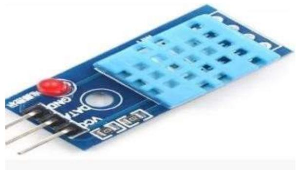
Figure 3 DHT11 Sensor
