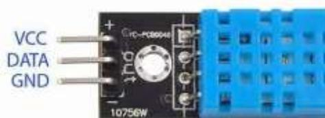
Figure 3 DHT11 Sensor
