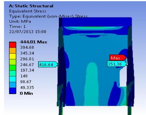
**2) FINITE ELEMENT ANALYSIS OF SEAT BACKREST OF CAR (STAGE-II)**
