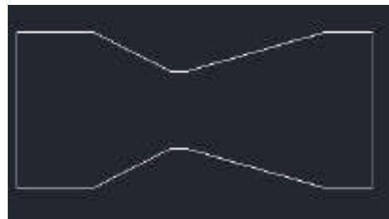
Fig.1- Venturie Nozzle pipe
